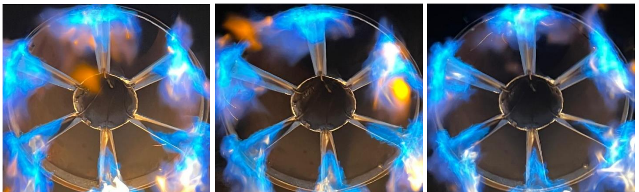
Рисунок 4.3 – Угловые стабилизаторы с углом 60^{\circ} [119, с. 239]
