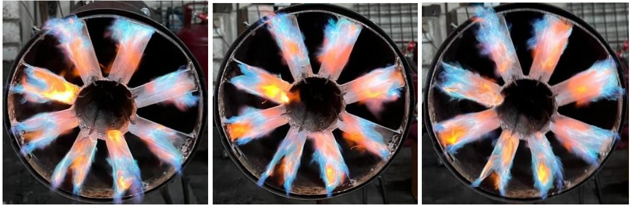
Рисунок 4.1 – Угловые стабилизаторы виде полукруг
