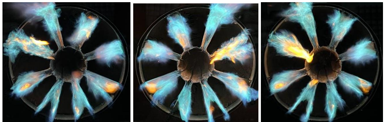
Рисунок 4.2 – Угловые стабилизаторы с углом 45^{\circ}
