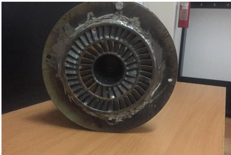
Сурет 3.3 - Қарсы айналмалы ағындары бар микрофакель құрылғысы.
