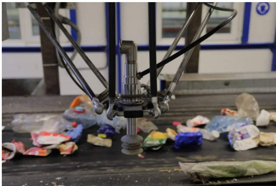
Сурет 1.21 - «РТ-Инвест» компаниясы 2021 жылдан бастап қалдықтарды қайта өңдеу кешендерінде қоқыстарды сұрыптау үшін құрастырған роботы [87].
