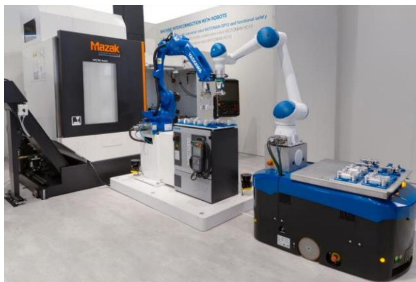
Сурет 1.14 - Мобильді роботтық жүйемен машиналарға техникалық қызмет көрсету
