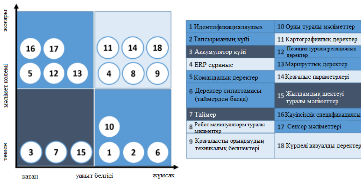
Сурет 1.16 - Мобильді роботты пайдалану мысалдарын талдау барысында анықталған деректер көлемі және ақпараттың нақты уақыт талаптары
