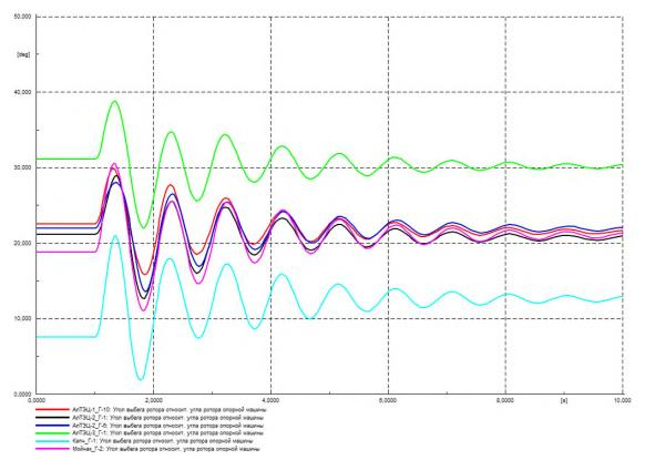
Рисунок Г.17 – Угол ротора генераторов на контролируемых ЭС, град.
