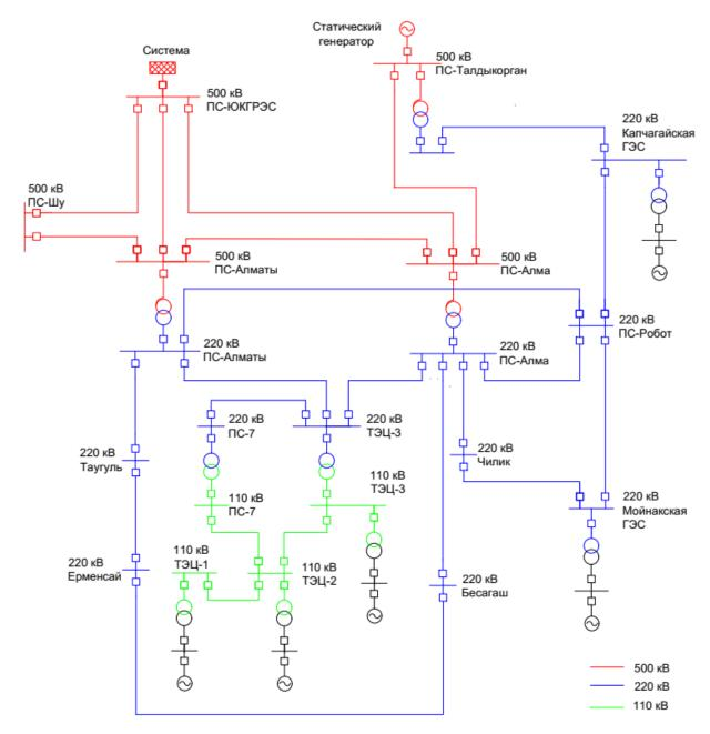
Рисунок 2.7 – Укрупненная электрическая схема Алматинского энергоузла
