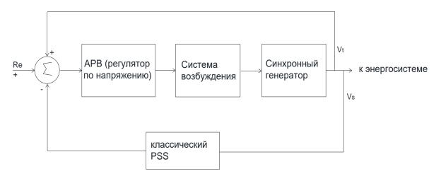
Рисунок 3.1 – Схема регулирования при классическом PSS.
