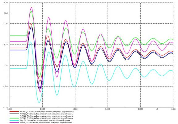
Рисунок Г.9 – Угол ротора генераторов на контролируемых ЭС, град.
