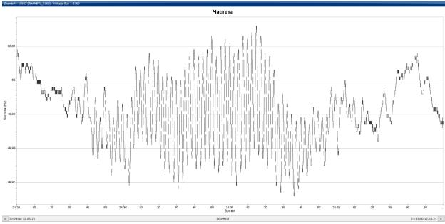
Рисунок А.12 – График изменения частоты на ПС «Жамбыл» при НЧК в ЕЭС РК,  $\Gamma$ ц
