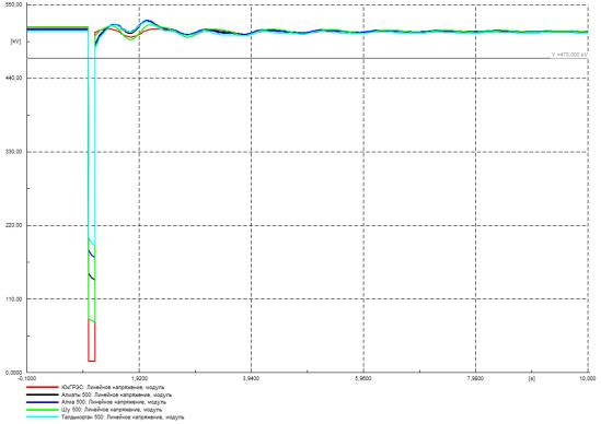
Рисунок Г.86 – Напряжение в контролируемых узлах 500 кВ, кВ
