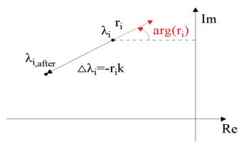
Рисунок 3.4 — Смещение собственных значений за счет передаточной функции обратной связи с коэффициентом усиления K
