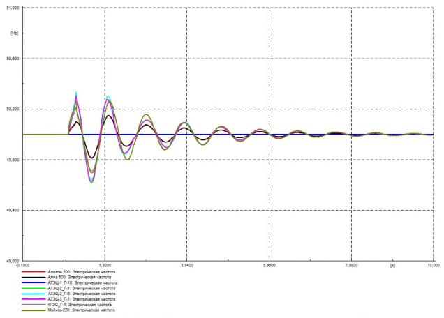
Рисунок Г.71 – Частота в контролируемых узлах, Гц
