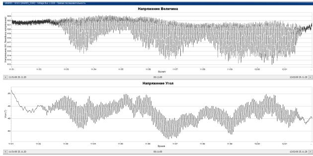
Рисунок А.2 – График изменения напряжения на ПС «ЮКГРЭС» при НЧК в ЕЭС РК, кВ
