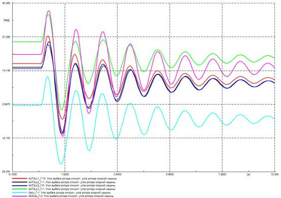
Рисунок Г.41 – Угол ротора генераторов на контролируемых ЭС, град.
