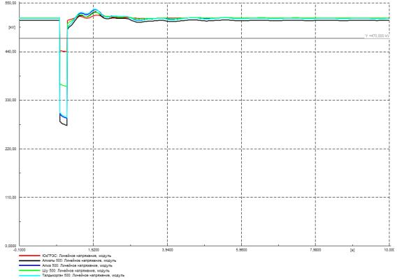
Рисунок Г.70 – Напряжение в контролируемых узлах 500 кВ, кВ
