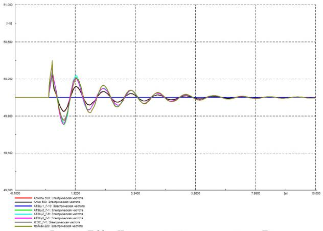
Рисунок Г.39 – Частота в контролируемых узлах, Гц
