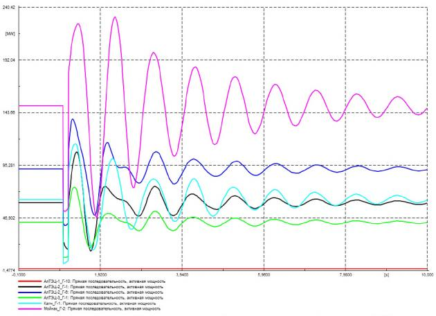
Рисунок Г.64 – Выдача активной мощности генераторов, МВт
