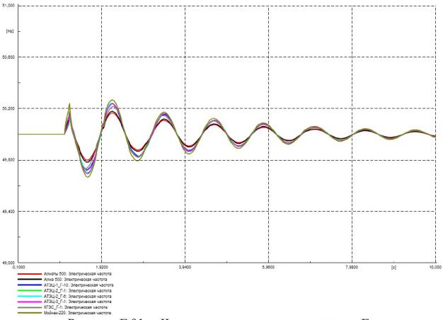
Рисунок Г.91 – Частота в контролируемых узлах, Гц
