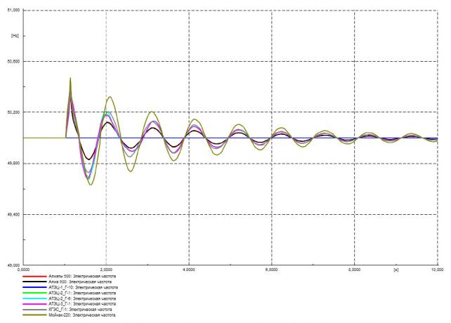
Рисунок Г.15 – Частота в контролируемых узлах, Гц
