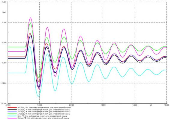
Рисунок Г.57 – Угол ротора генераторов на контролируемых ЭС, град.
