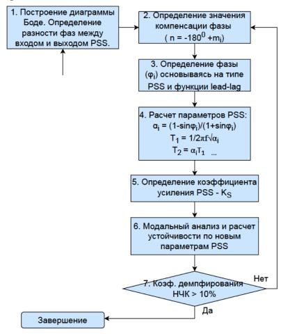
Рисунок 3.10 – Блок-схема по расчету параметров PSS
