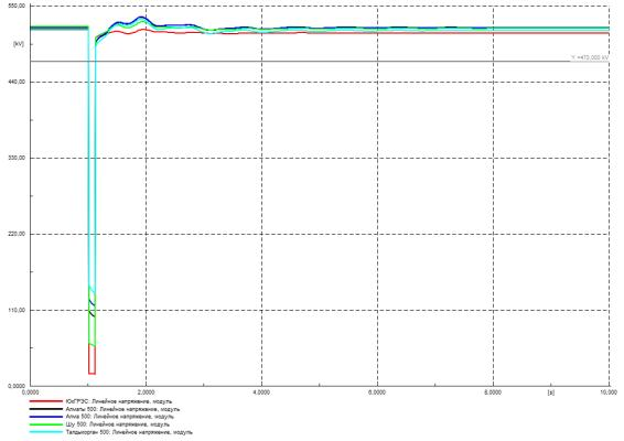
Рисунок Г.6 – Напряжение в контролируемых узлах 500 кВ, кВ
