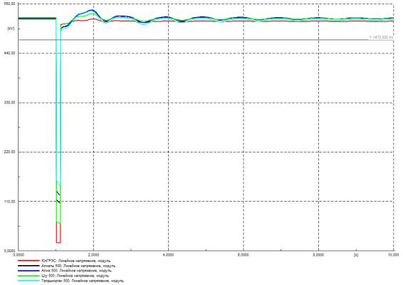
Рисунок Г.14 – Напряжение в контролируемых узлах 500 кВ, кВ
