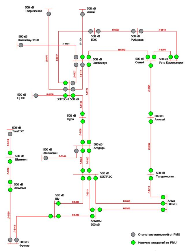
Рисунок 2.2 – Места установки устройств РМU в сети 500 кВ НЭС Казахстана
