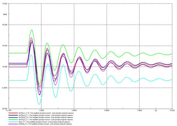
Рисунок Г.49 – Угол ротора генераторов на контролируемых ЭС, град.
