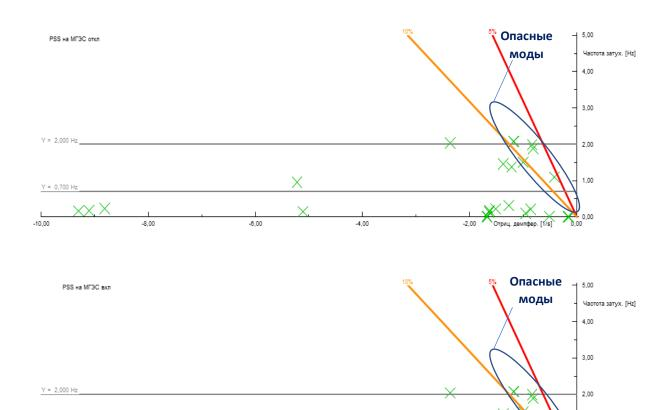
Рисунок 2.14 — Модальный анализ при отключенном (верхний график) и включенном (нижний график) PSS на генераторах МГЭС (возмущение № 2).
