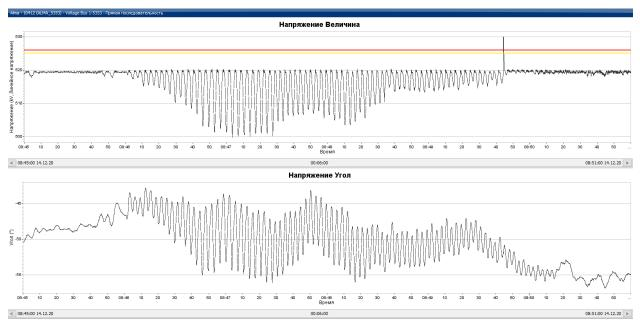
Рисунок А.5 – График изменения напряжения на ПС «Алма» при НЧК в ЕЭС РК, кВ
