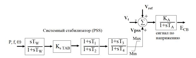
Рисунок 3.8 – Передаточная функция PSS и регулятора напряжения
