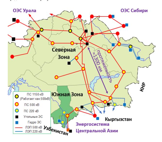
Рисунок 2.1 – Схема транзита «Север-Юг» НЭС Казахстана
