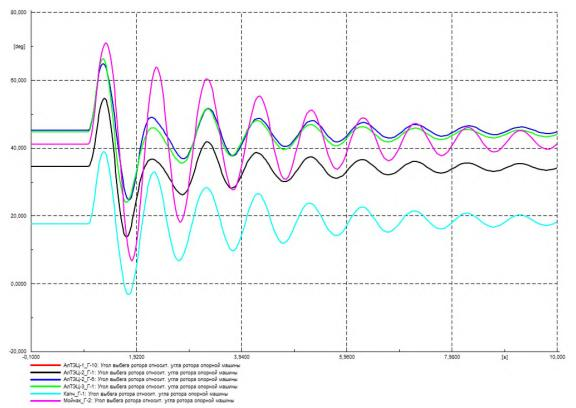
Рисунок Г.61 – Угол ротора генераторов на контролируемых ЭС, град.
