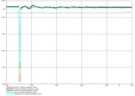
Рисунок Г.10 – Напряжение в контролируемых узлах 500 кВ, кВ
