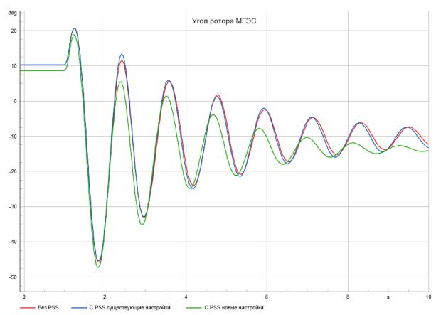
Рисунок 3.19 — Сравнительный график угла вращения ротора генератора, угол
