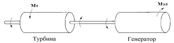
Рисунок. 1.9 – Вращение турбины и генератора на валу
