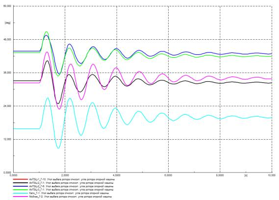
Рисунок Г.21 – Угол ротора генераторов на контролируемых ЭС, град.
