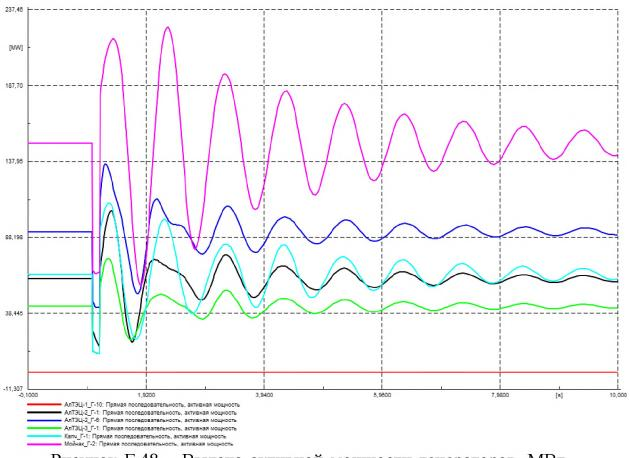
Рисунок Г.48 – Выдача активной мощности генераторов, МВт
