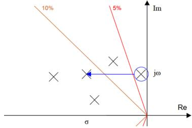
Рисунок 3.11. — Смещение расположения моды НЧК на плоскости при настройке PSS
