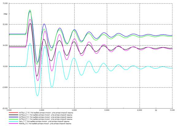
Рисунок Г.5 – Угол ротора генераторов на контролируемых ЭС, град.
