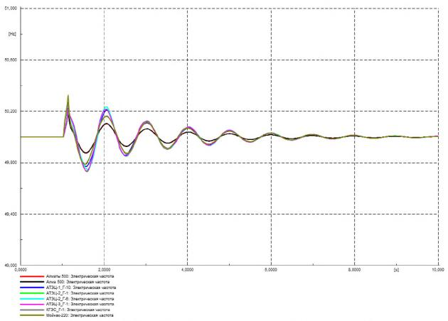
Рисунок Г.3 – Частота в контролируемых узлах, Гц
