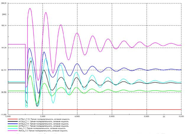
Рисунок Г.8 – Выдача активной мощности генераторов, МВт
