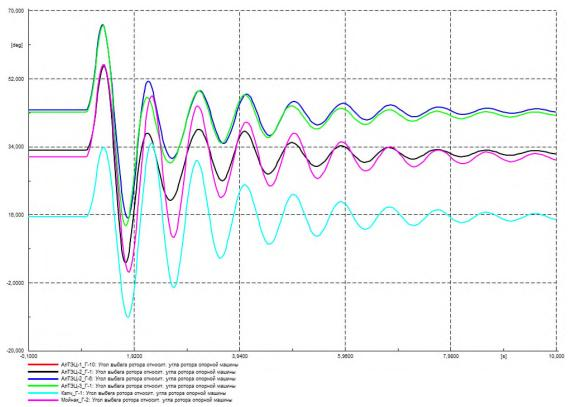
Рисунок Г.69 – Угол ротора генераторов на контролируемых ЭС, град.
