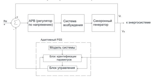
Рисунок 3.2 – Схема регулирования с адаптивным PSS.
