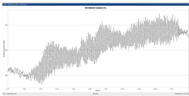
Рисунок А.1 – График изменения активной мощности по ВЛ «Шу-Фрунзе» при НЧК в ЕЭС РК, МВт
