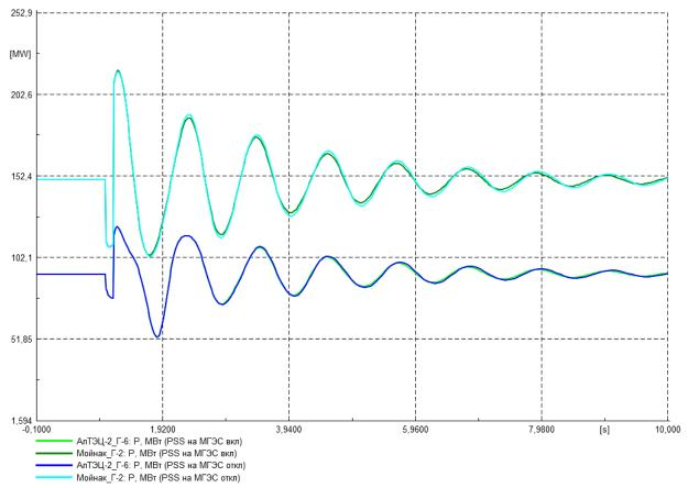
Рисунок 2.15 — Сравнительный график при включенном и отключенном PSS на генераторах МГЭС. Ремонтная схема (выведены в ремонт 2 ВЛ-500 кВ Актогай- Талдыкорган и Алма-ЮКГРЭС). Отключение ВЛ-500 кВ «ЮКГРЭС-Алматы» с двухфазным КЗ на землю. Зимний режим.
