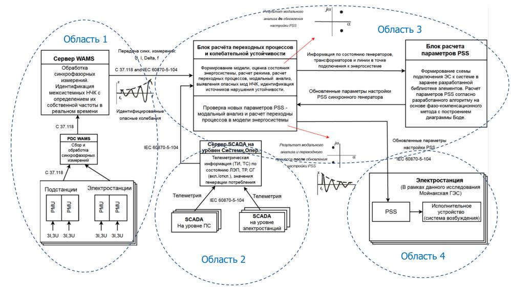
Рисунок 4.3. - Общая функциональная архитектура WADS ЕЭС Казахстана
