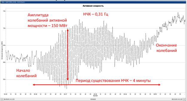
Рисунок 2.5 — График изменения активной мощности по ВЛ-500кВ «Шу- Фрунзе», МВт
