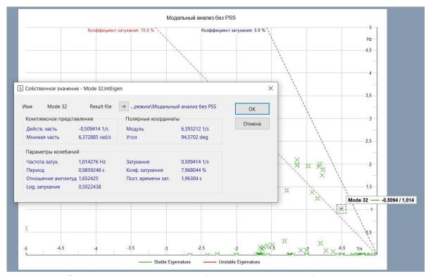
Рисунок 3.22 — Расчет eigenvalue (модальный анализ) после изменения параметров настройки PSS согласно алгоритму
