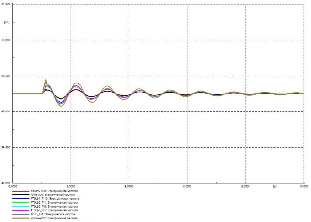
Рисунок Г.27 – Частота в контролируемых узлах, Гц
