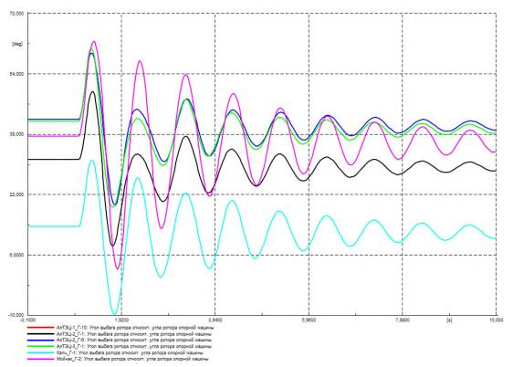
Рисунок Г.45 – Угол ротора генераторов на контролируемых ЭС, град.
