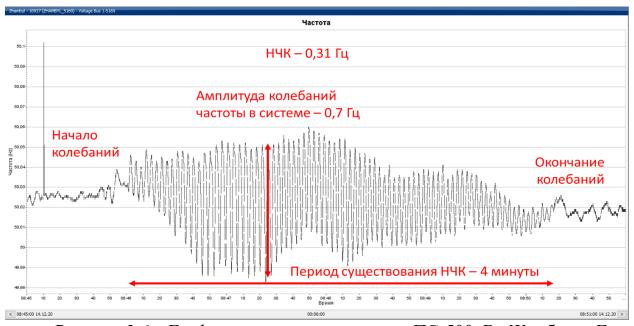
Рисунок 2.6 – График изменения частоты на ПС-500кВ «Жамбыл», Гц
