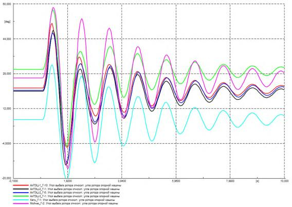
Рисунок Г.73 – Угол ротора генераторов на контролируемых ЭС, град.
