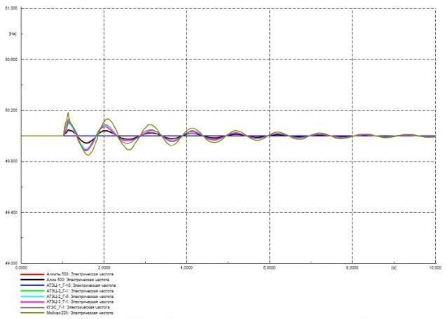
Рисунок Г.31 – Частота в контролируемых узлах, Гц
