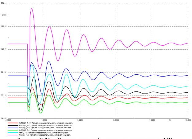
Рисунок Г.36 – Выдача активной мощности генераторов, МВт
