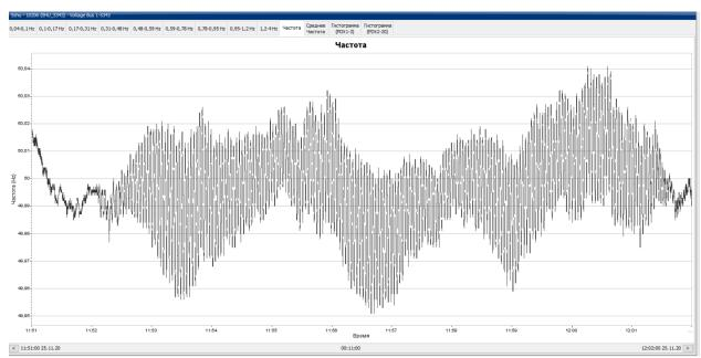
Рисунок А.3 – График изменения частоты на ПС «Шу» при НЧК в ЕЭС РК,  $\Gamma$ ц
