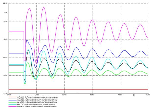
Рисунок 2.10 – Выдача активной мощности генераторов на электростанциях Алматинского энергоузла при характерном возмущении, МВт
