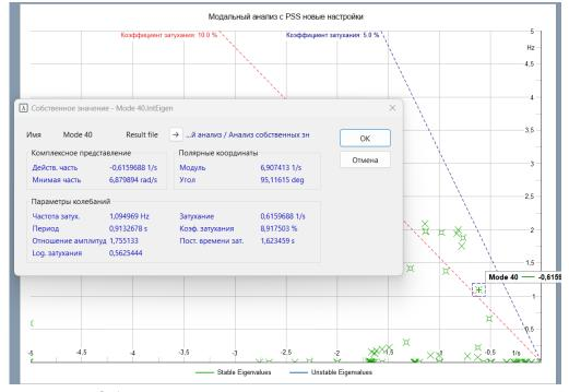
Рисунок 3.15. – Модальный анализ при расчете параметров PSS
