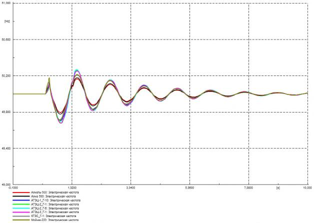
Рисунок Г.83 – Частота в контролируемых узлах, Гц
