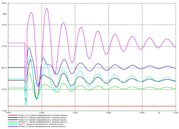
Рисунок Г.16 – Выдача активной мощности генераторов, МВт
