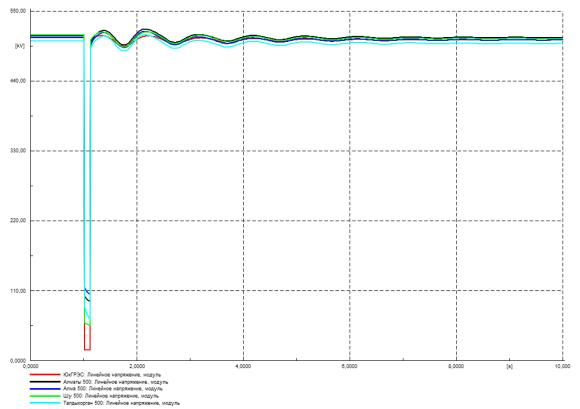
Рисунок Г.2 – Напряжение в контролируемых узлах 500 кВ, кВ
