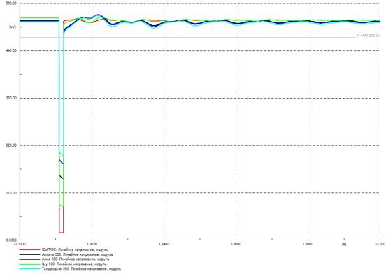
Рисунок Г.94— Напряжение в контролируемых узлах 500 кВ, кВ
