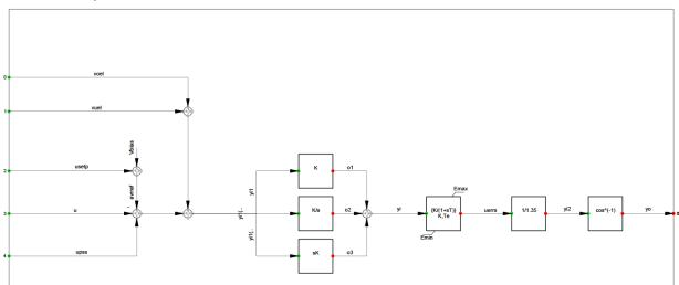
Рисунок 2.8 – Передаточная функция APB Мойнакской ГЭС в расчетной программе
