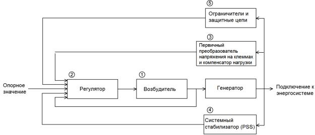
Рисунок 1.15 — Функциональная схема управления системы возбуждения совместно с PSS
