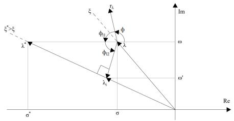
Рисунок 3.6 – Поиск оптимального сдвига угла при настройке PSS
