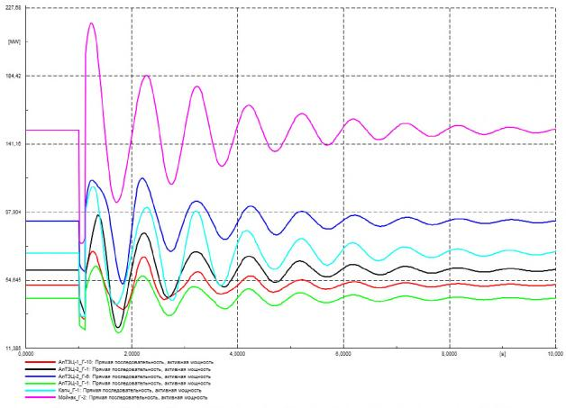
Рисунок Г.4 – Выдача активной мощности генераторов, МВт
