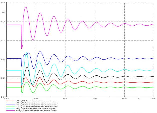
Рисунок Г.20 – Выдача активной мощности генераторов, МВт
