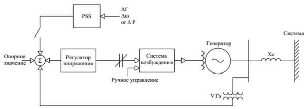
Рисунок 1.18 – Структура управления синхронным генератором
