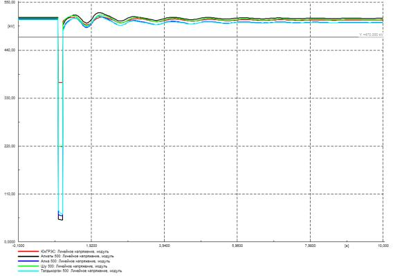
Рисунок Г.50 – Напряжение в контролируемых узлах 500 кВ, кВ
