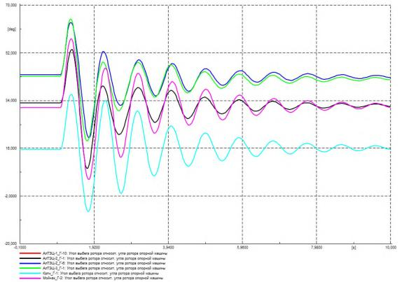
Рисунок Г.53 – Угол ротора генераторов на контролируемых ЭС, град.
