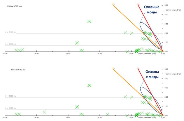
Рисунок 2.12 – Модальный анализ при отключенном (верхний график) и включенном (нижний график) PSS на генераторах МГЭС (возмущение № 1).
