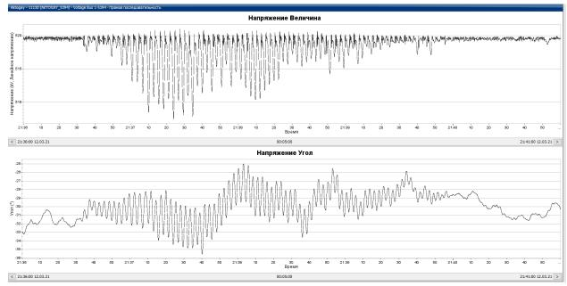
Рисунок А.14 – График изменения напряжения на ПС «Актогай» при НЧК в ЕЭС РК, кВ
