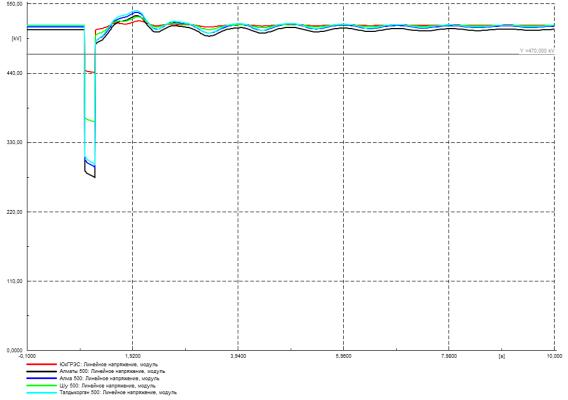
Рисунок Г.78 – Напряжение в контролируемых узлах 500 кВ, кВ
