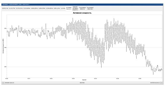
Рисунок А.16 – График изменения активной мощности по ВЛ «Шымкент-Жамбыл» при НЧК в ЕЭС РК, МВт
