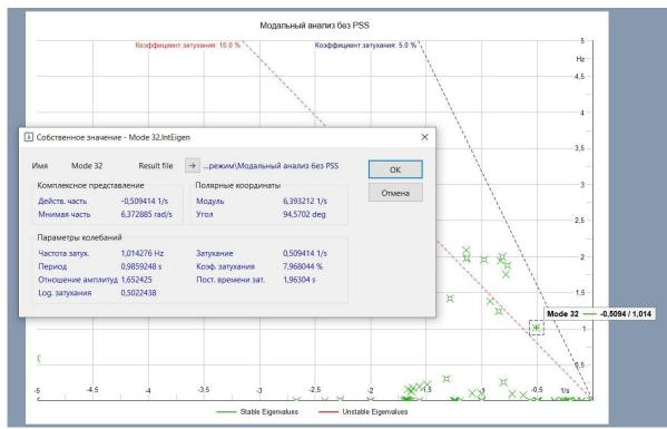
Рисунок 3.13 – Модальный анализ, определение опасной моды НЧК (без PSS)
