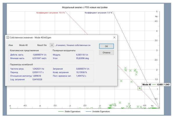
Рисунок 3.24 — Pacчет eigenvalue (модальный анализ) после изменения параметров настройки PSS согласно алгоритму
