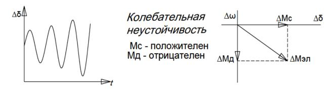
Рисунок 1.8 — Реакция генератора на малое возмущение с учетом системы возбуждения.
