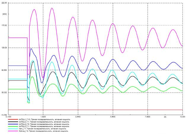
Рисунок Г.96 – Выдача активной мощности генераторов, МВт
