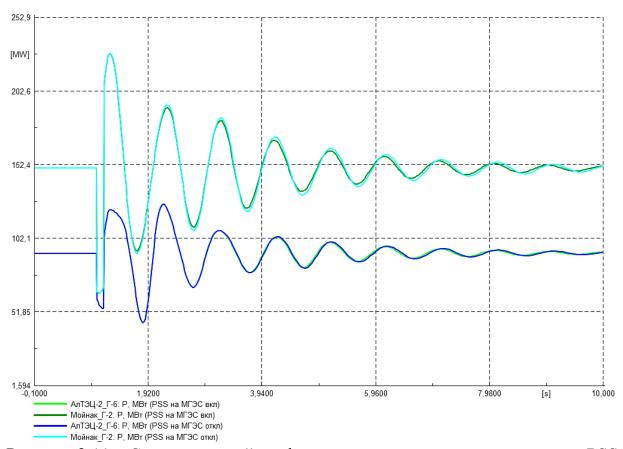
Рисунок 2.11 — Сравнительный график при включенном и отключенном PSS на генераторах МГЭС. При нормальной схеме и отключением ВЛ-500 кВ «ЮКГРЭС-Алматы» с двухфазным КЗ на землю. Зимний режим.
