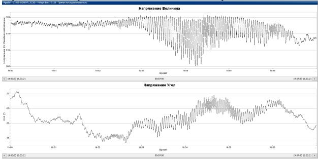
Рисунок А.17 – График изменения напряжения на ПС «Агадырь» при НЧК в ЕЭС РК, кВ
