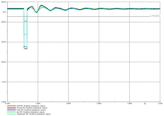
Рисунок Г.66 – Напряжение в контролируемых узлах 500 кВ, кВ
