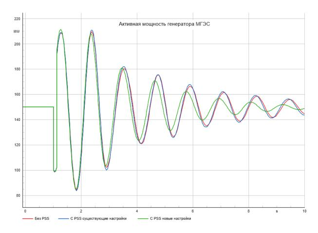
Рисунок 3.18 – Сравнительный график активной мощности генераторов, МВт
