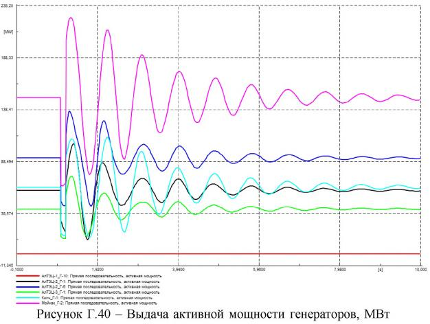
Возмущение 3.3. Схема сети — ремонтная (отключен восточный транзит); режим работы МГЭС — выдача 300 МВт; исходный режим для расчета — зимний максимум; возмущение — отключение ВЛ-500 кВ «ЮКГРЭС-Алматы» и ШР на ПС-500 кВ «Алматы» с двухфазным КЗ на землю длительностью 0,12.
