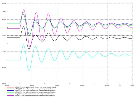
Рисунок Г.29 – Угол ротора генераторов на контролируемых ЭС, град.
