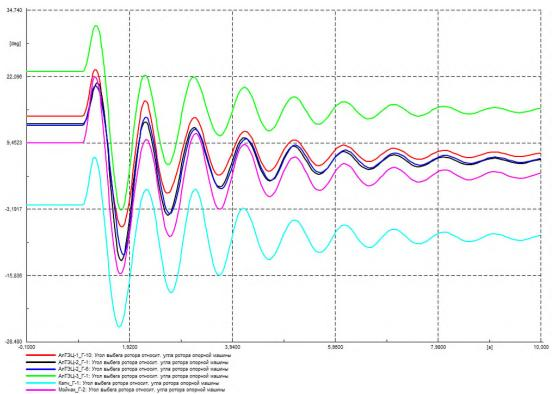
Рисунок Г.33– Угол ротора генераторов на контролируемых ЭС, град.
