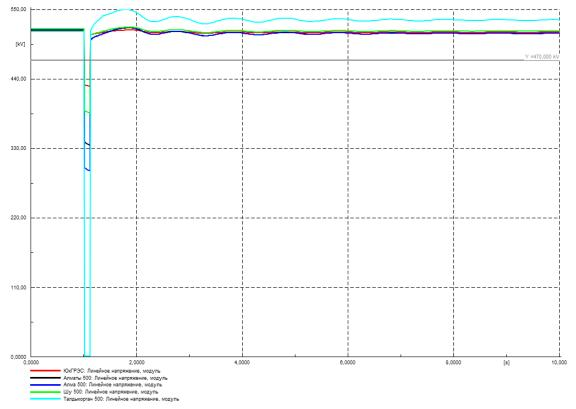
Рисунок Г.30 – Напряжение в контролируемых узлах 500 кВ, кВ
