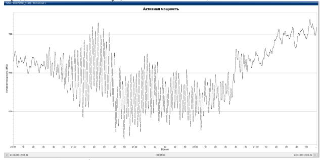
Рисунок А.13 – График изменения активной мощности по ВЛ «Шу-Фрунзе» при НЧК в ЕЭС РК, МВт
