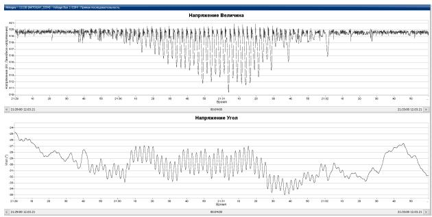
Рисунок А.11 – График изменения напряжения на ПС «Актогай» при НЧК в ЕЭС РК, кВ
