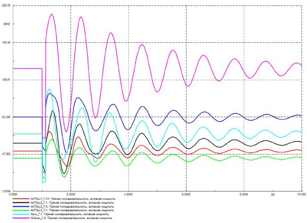
Рисунок Г.12 – Выдача активной мощности генераторов, МВт
