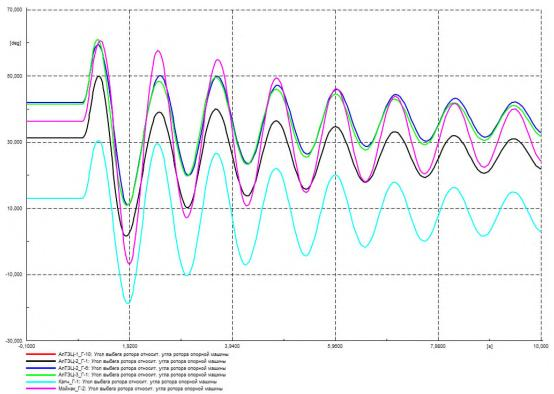
Рисунок Г.93 – Угол ротора генераторов на контролируемых ЭС, град.
