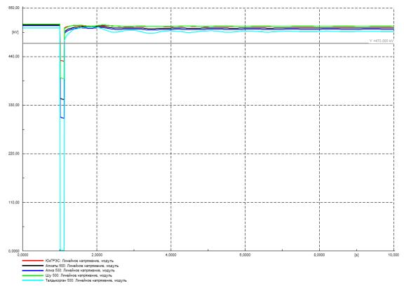
Рисунок Г.26 – Напряжение в контролируемых узлах 500 кВ, кВ
