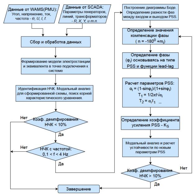
Рис. 4.5- Блок-схема алгоритма идентификации и демпфирования НЧК
