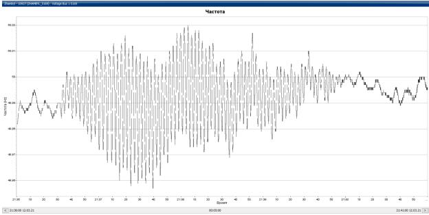
Рисунок А.15 – График изменения частоты на ПС «Жамбыл» при НЧК в ЕЭС РК,  $\Gamma$ ц
