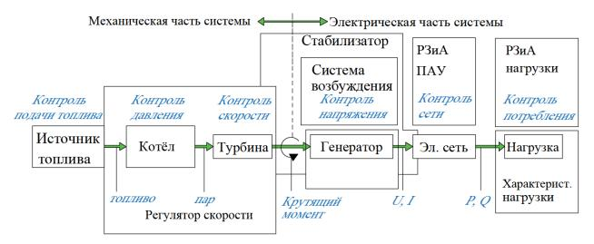
Рисунок 1.14. — Структура полного цикла производства и потребления электроэнергии
