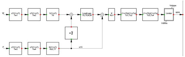
Рисунок 2.9 – Передаточная функция PSS Мойнакской ГЭС в расчетной программе
