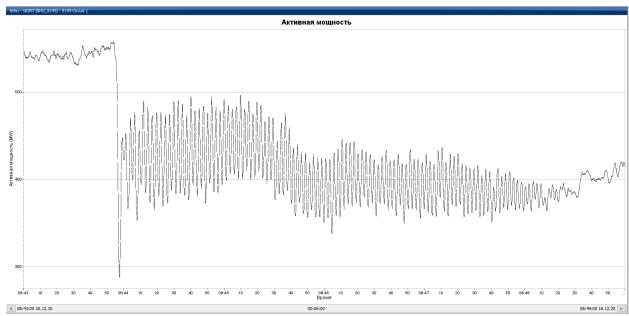
Рисунок А.7 – График изменения активной мощности по ВЛ «Шу-Фрунзе» при НЧК в ЕЭС РК, МВт
