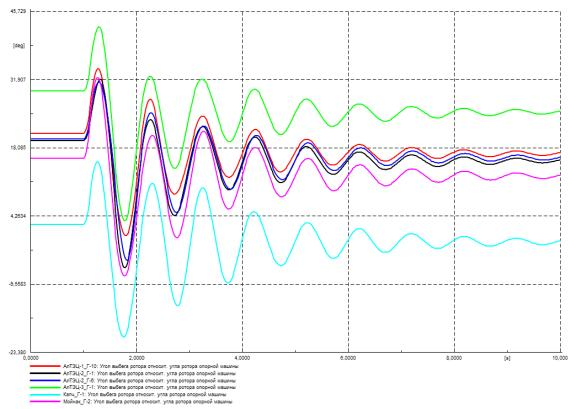
Рисунок Г.1 – Угол ротора генераторов на контролируемых ЭС, град.
