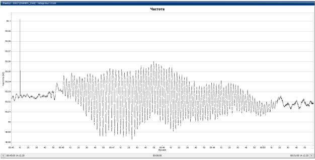
Рисунок А.6 – График изменения частоты на ПС «Жамбыл» при НЧК в ЕЭС РК, Гц
