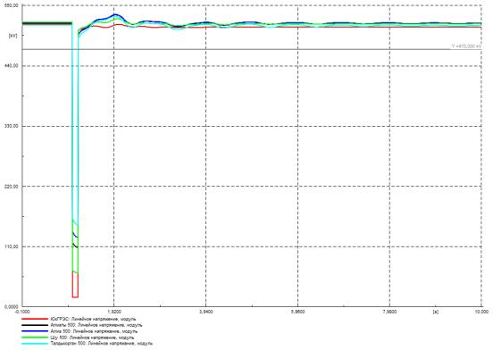
Рисунок Г.46 – Напряжение в контролируемых узлах 500 кВ, кВ
