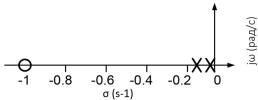
Рисунок 4.6 — Расположение корней характеристического уровне на sплоскости.
