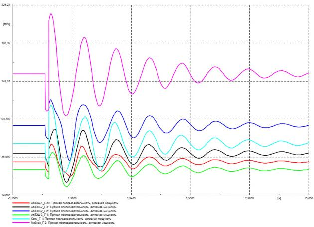
Рисунок Г.84 – Выдача активной мощности генераторов, МВт
