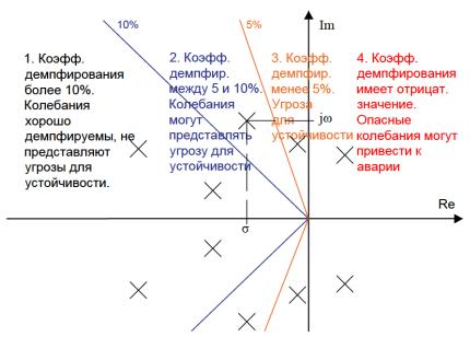
Рисунок 1.12 – Расположение корней характеристического уравнения на s-плоскости
