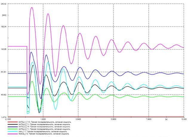
Рисунок Г.56 – Выдача активной мощности генераторов, МВт
