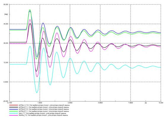
Рисунок Г.37 – Угол ротора генераторов на контролируемых ЭС, град.
