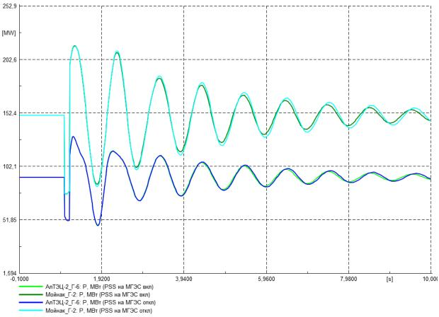
Рисунок 2.17 — Сравнительный график при включенном и отключенном PSS на генераторах МГЭС. Ремонтная схема (выведены в ремонт 2 ВЛ-500 кВ Актогай- Талдыкорган и Алма-ЮКГРЭС). Отключение ВЛ-500 кВ «ЮКГРЭС-Алматы» с двухфазным КЗ на землю. Летний режим.
