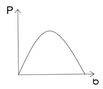
Рисунок 1.5 – Характеристика мощности генератора
