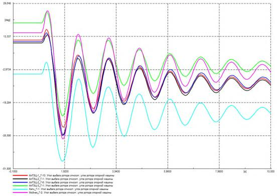
Рисунок Г.89 – Угол ротора генераторов на контролируемых ЭС, град.
