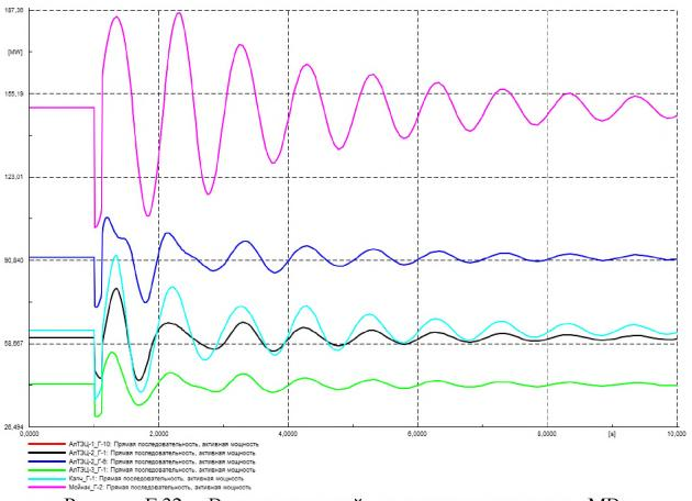
Рисунок Г.32 – Выдача активной мощности генераторов, МВт
