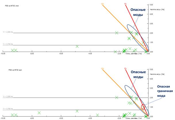
Рисунок 2.18 – Модальный анализ при отключенном (верхний график) и включенном PSS с текущими настройками (нижний график) на Мойнакской ГЭС.
