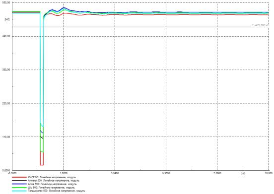
Рисунок Г.38 – Напряжение в контролируемых узлах 500 кВ, кВ
