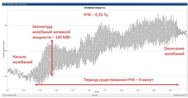
Рисунок 2.3 — График изменения активной мощности по ВЛ-500кВ «Шу- Фрунзе», МВт
