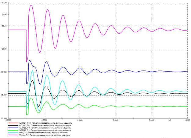
Рисунок Г.24 – Выдача активной мощности генераторов, МВт
