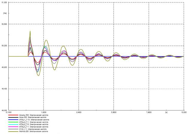
Рисунок Г.63 – Частота в контролируемых узлах, Гц
