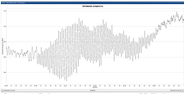
Рисунок А.4 – График изменения активной мощности по ВЛ «Шу-Фрунзе» при НЧК в ЕЭС РК, МВт
