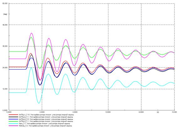
Рисунок Г.25 – Угол ротора генераторов на контролируемых ЭС, град.
