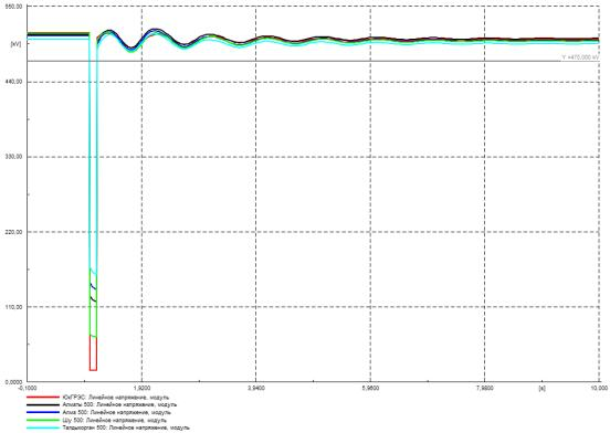
Рисунок Г.34 – Напряжение в контролируемых узлах 500 кВ, кВ
