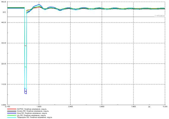
Рисунок Г.62 – Напряжение в контролируемых узлах 500 кВ, кВ
