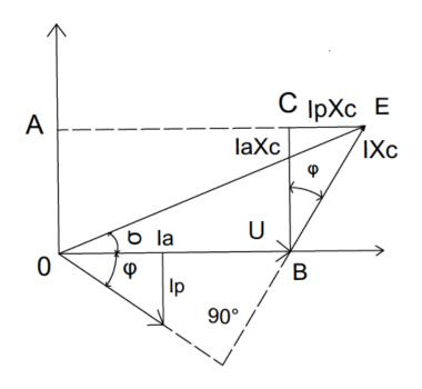
Рисунок 1.4 – Векторная диаграмма нормального режима работы генератора
