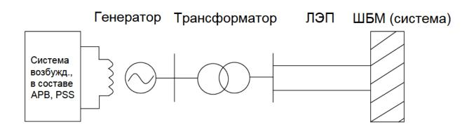
Рисунок 3.9. Формируемая модель синхронного генератора
