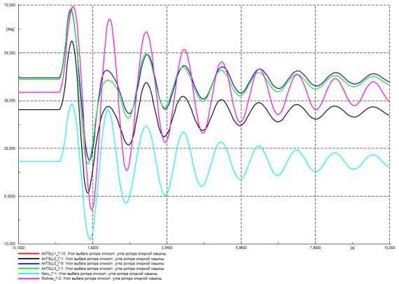
Рисунок Г.77 – Угол ротора генераторов на контролируемых ЭС, град.
