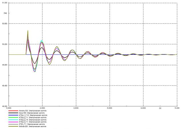
Рисунок Г.7 – Частота в контролируемых узлах, Гц
