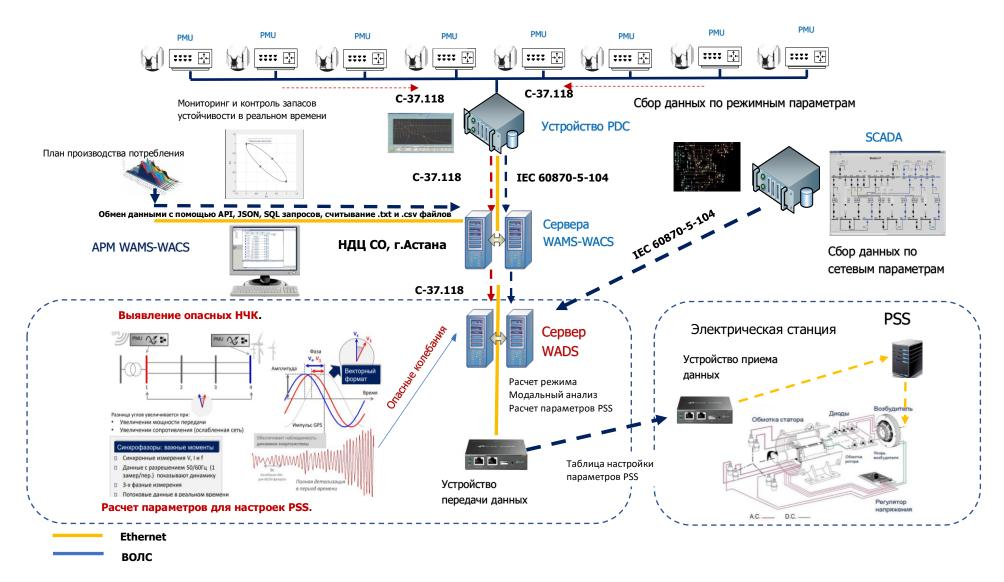
Рисунок 4.4 – Технико-технологическая реализация WADS системы.
