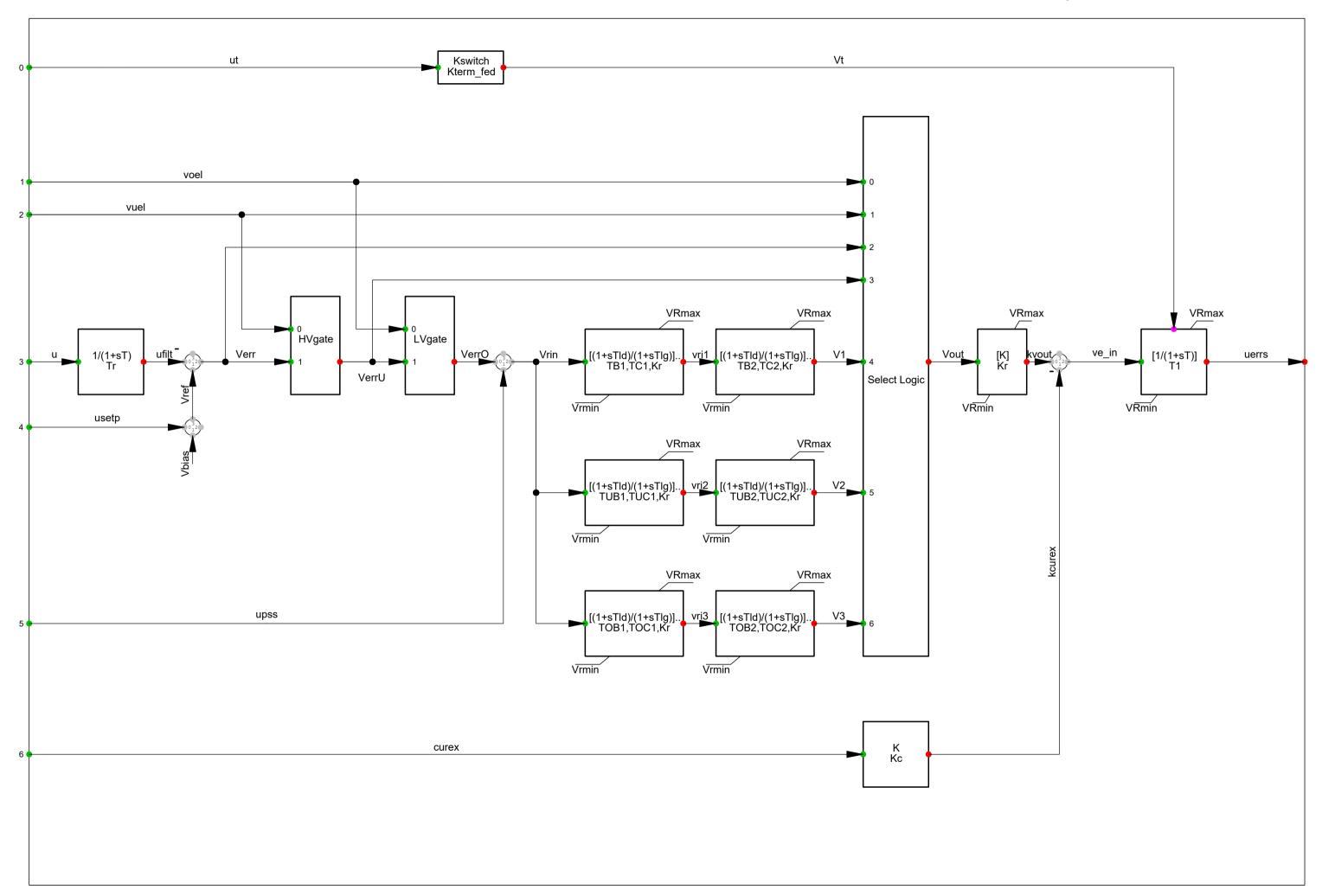
Передаточные функции модели АР пропорционального действия
