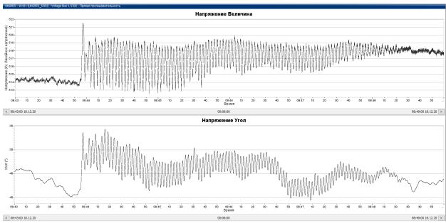
Рисунок А.8 – График изменения напряжения на ПС «ЮКГРЭС» при НЧК в ЕЭС РК, кВ
