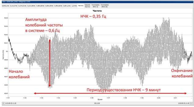
Рисунке 2.4 – График изменения частоты на ПС-500кВ «Шу», Гц
