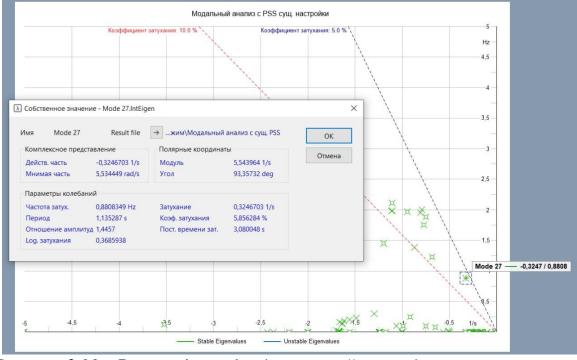
Рисунок 3.23 – Расчет eigenvalue (модальный анализ) при существующих параметрах настройки PSS
