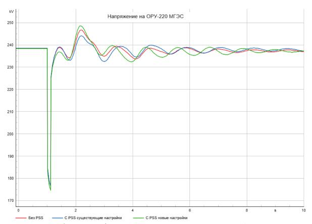
Рисунок 3.21 – График напряжения на шинах ОРУ-220 МГЭС, кВ
