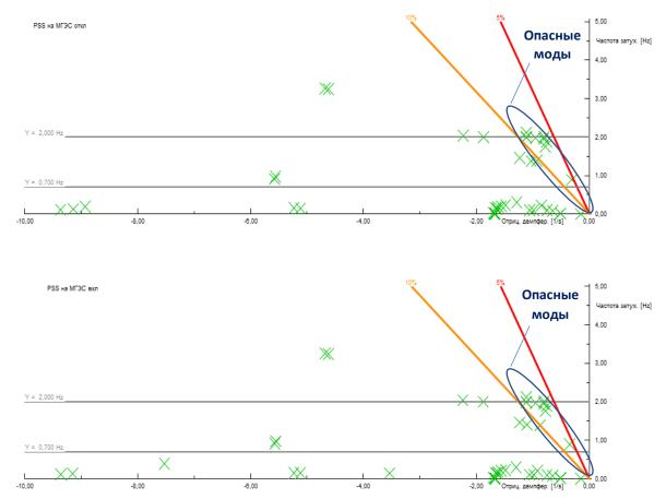
Рисунок 2.16 – Модальный анализ при отключенном (верхний график) и включенном (нижний график) PSS на генераторах МГЭС (возмущение № 3).
