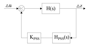
Рисунок 3.3 – Упрощенная схема обратной связи PSS
