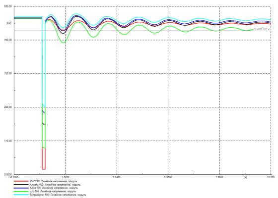
Рисунок Г.90 – Напряжение в контролируемых узлах 500 кВ, кВ
