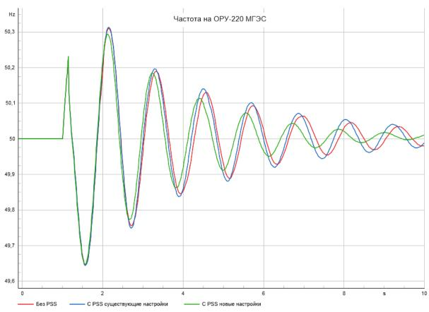
Рисунок 3.20 — Сравнительный график частоты на шинах ОРУ-220 МГЭС,  $\Gamma$ ц
