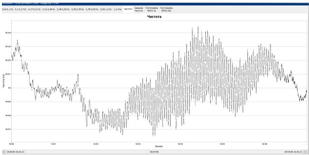
Рисунок А.18 – График изменения частоты на ПС «Шымкент» при НЧК в ЕЭС РК, Гц
