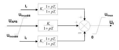
Рисунок 1.16 – Передаточная функция АРВ-ПД
