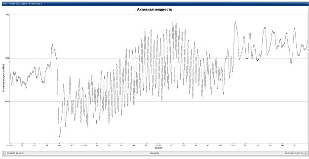
Рисунок А.10 – График изменения активной мощности по ВЛ «Шу-Фрунзе» при НЧК в ЕЭС РК, МВт
