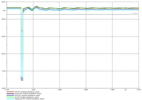
Рисунок Г.58 – Напряжение в контролируемых узлах 500 кВ, кВ
