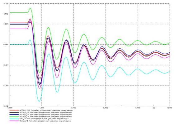
Рисунок Г.81 – Угол ротора генераторов на контролируемых ЭС, град.
