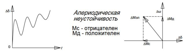
Рисунок 1.7 – Реакция генератора на малое возмущение при постоянном значении напряжения.
