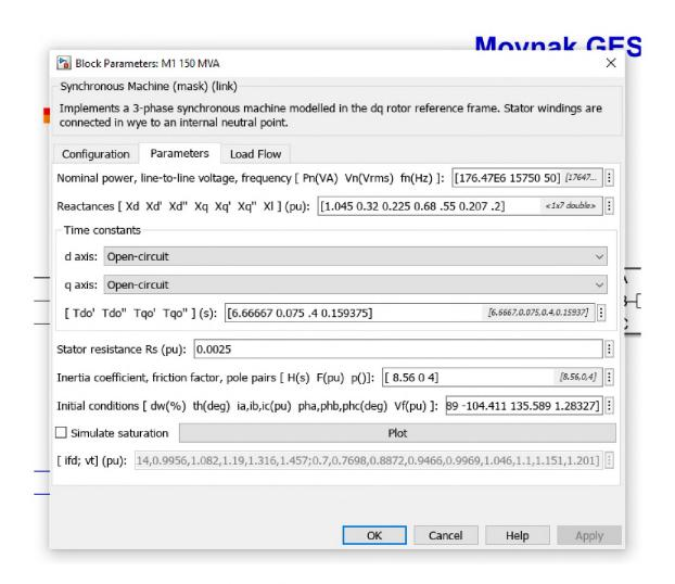
Рисунок Е.4 - Параметры генератора
