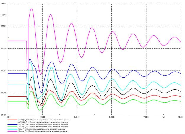
Рисунок Г.92 – Выдача активной мощности генераторов, МВт
