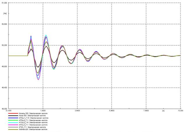
Рисунок Г.67 – Частота в контролируемых узлах, Гц
