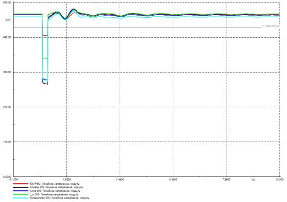
Рисунок Г.74 – Напряжение в контролируемых узлах 500 кВ, кВ
