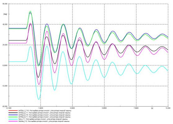
Рисунок Г.85 – Угол ротора генераторов на контролируемых ЭС, град.
