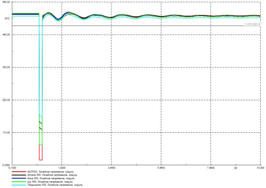
Рисунок Г.42 – Напряжение в контролируемых узлах 500 кВ, кВ
