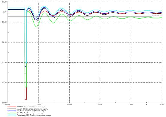
Рисунок Г.82 – Напряжение в контролируемых узлах 500 кВ, кВ
