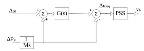
Рисунок 1.19 – Передаточная функция PSS
