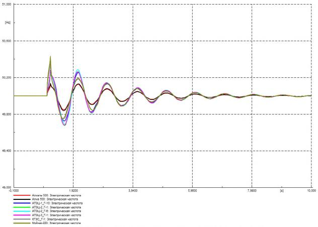
Рисунок Г.51 – Частота в контролируемых узлах, Гц
