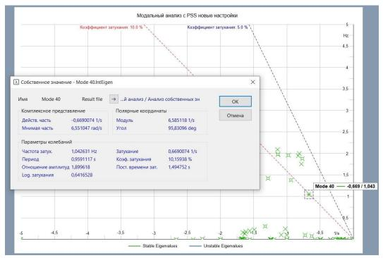
Рисунок 3.17. – Модальный анализ при расчете параметров PSS
