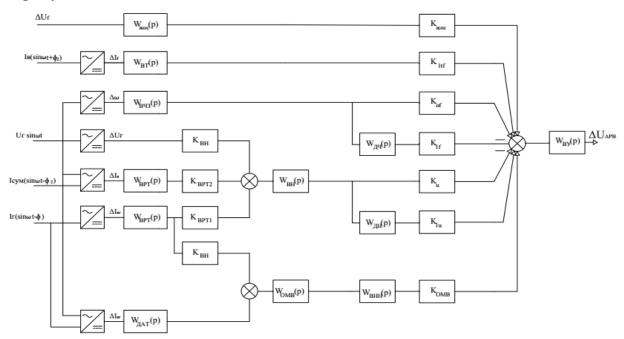
Рисунок 1.17 – Передаточная функция АРВ-СД
