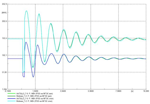
Рисунок 2.13 — Сравнительный график при включенном и отключенном PSS на генераторах МГЭС. При нормальной схеме и отключением ВЛ-500 кВ «ЮКГРЭС-Алматы» с двухфазным КЗ на землю. Летний режим.
