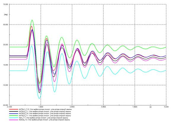
Рисунок Г.65 – Угол ротора генераторов на контролируемых ЭС, град.
