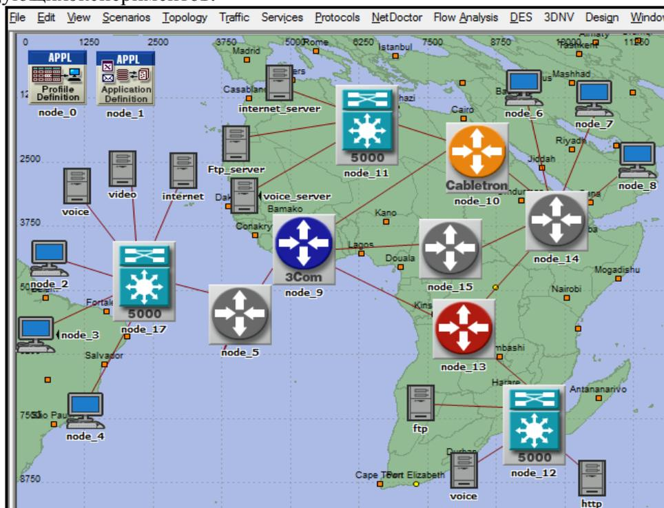
Рисунок 1– Разработанная имитационная модель сети
