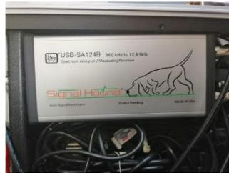
Рисунок 2 – Модуль анализатора спектра USB-SA124B (100 кГц-12.4 ГГц)
