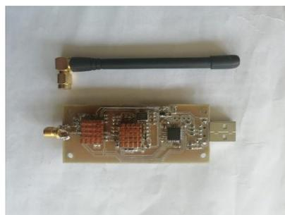
Рисунок 5 – Внешний вид USB-генератора и его антенны
